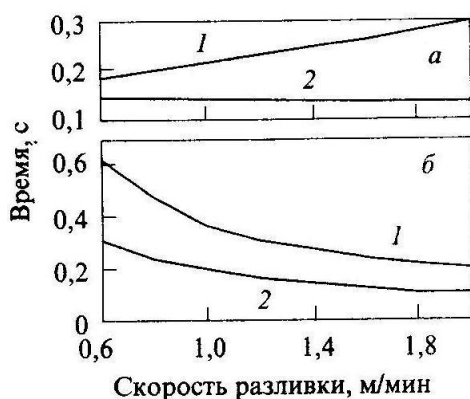
Рис. 9. Длительность положительного (1) и отрицательного (2) шага для режима инвертированного (а) и обычного (б) качания кристаллизатора [27]
